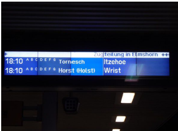
Abbildung 53: Die Darstellung von Bahnsteigabschnitten auf dem Zugzielanzeiger in Pinneberg ist nicht sinnvoll, solange diese nicht auf dem Bahnsteig markiert sind und die Zughalteposition nicht auch angegeben wird.
