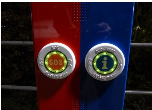
Abbildung 33: Am 22.11.2017 funktionierten die Informationssäulen der AKN trotz grüner Tastenbeleuchtung nicht. Notrufe waren jedoch möglich.
