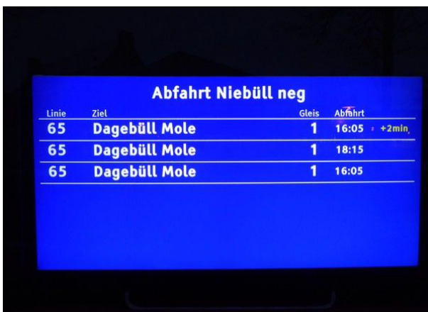
Abbildung 21: Auf dem Abfahrtsmonitor am Zugang zum Bahnsteig des Bahnhofs Niebüll neg wurde eine Abfahrt zweimal dargestellt. Einmal mit und einmal ohne Verspätung. Dazwischen steht noch der Folgezug.
